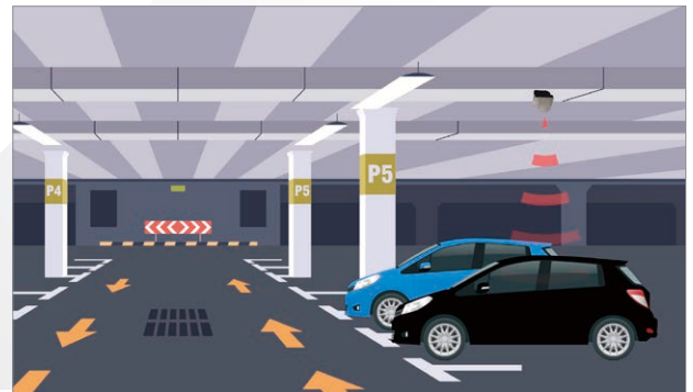
駐車場 施設駐車場の駐車スペースの車両有無検知 環境・車体色・大きさの影響を受けない高精度検知
