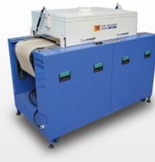
樹脂・プラスチック等の加熱・硬化に対応！コンパクトサイズで移動が楽々な床置型
