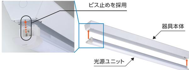
ビス止めにより、風の吹き込む軒下などでもLEDバーの浮きや外れを防ぐことができます。さらに、LEDバー端部にゴムパッキンを使用し、カバー内の防湿・防雨性能を強化しています。
