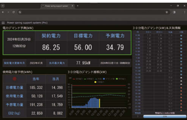
図1 デマンド電力監視画面
